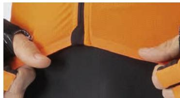
Il procedimento "bonded technology" consente l'unione di due tessuti senza utilizzare il metodo tradizionale di cucitura. Lo speciale nastro adesivo utilizzato in questo processo mantiene inalterate le proprietà elastiche dei tessuti, rafforzandone la resistenza e il comfort del capo poiché permette l'eliminazione dello sfregamento dato dalle cuciture.
